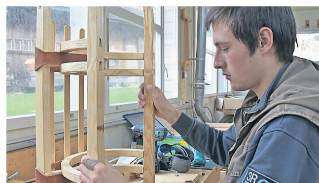
Wagnerlehrling Martin Hürzeler aus Grod SO bei der Arbeit. Charakteristisch für den Weissenstein-Schlitten sind die Bögen, die ineinandergreifen.
