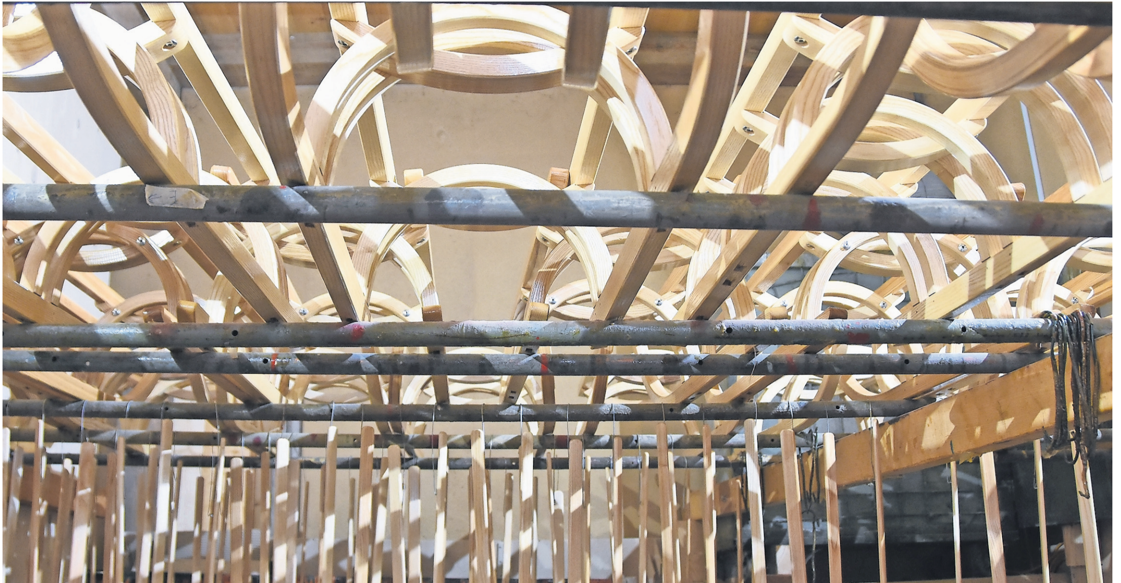
Blick in die Lackiererei. Deutlich sichtbar wird hier die spezielle Konstruktion der Schlitten, nämlich die ineinandergreifenden Bögen, die für eine spezielle Federwirkung sorgen.
